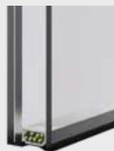
10 mm Verbundsicherheitsglas nach DIN EN 356 Klasse P4A . Bei Aluminium-Haustüren ist die Türfüllung/Verglasung im Flügelfalz zusätzlich gesichert.
