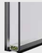
10 mm Verbundsicherheitsglas nach DIN EN 356 Klasse P4A . Bei Kunststoff-Haustüren ist die Türfüllung im Flügelfalz zusätzlich gesichert. Glasscheiben sind zusätzlich verklebt.
